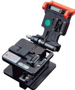
O Clivador de Precisão CLV-B1 para fibra óptica é uma ferramenta de alta precisão utilizada no processo de clivagens de fibras ópticas monomodo e multimodo. Essa ferramenta é indispensável no preparo da fibra óptica para processos de fusão e conectorização em campo.
